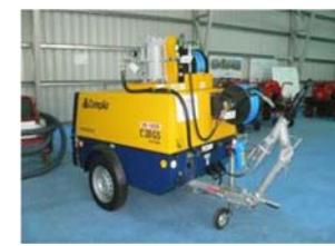
圖1：移動式空壓機
