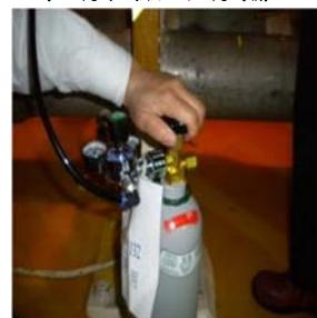
4.操作氣源鋼瓶調壓器，調壓至閥門全開
